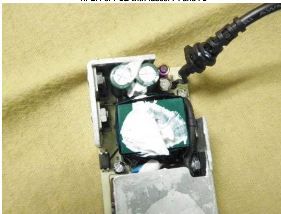
KPL: For PCB with fuses: F1 and F2
