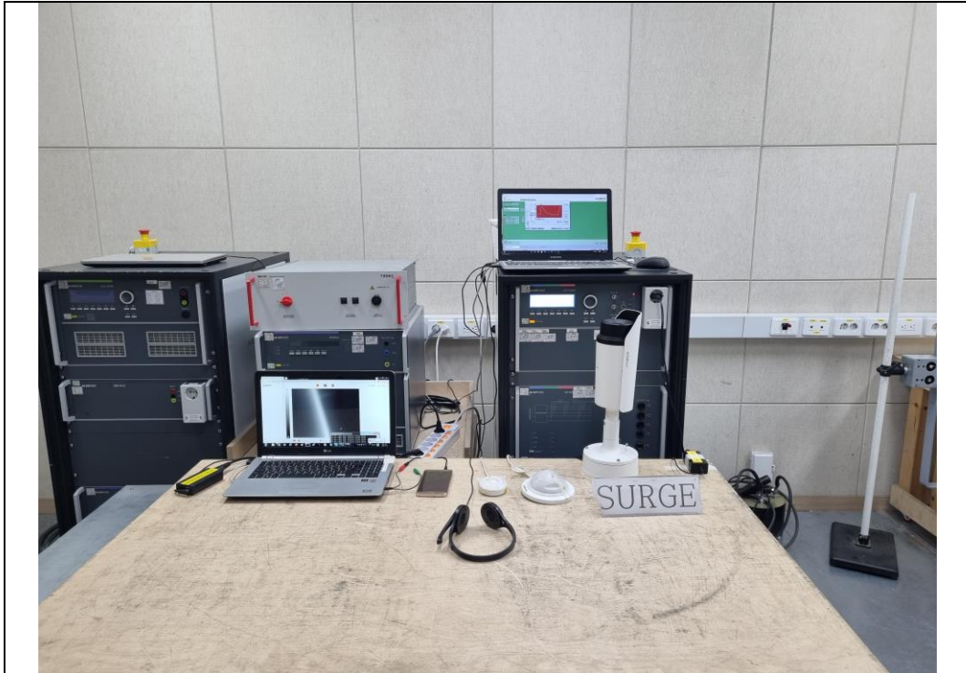
9.11 전도성 RF 전자기장 내성 시험 전 면 - AC, DC 모드
