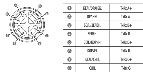
[Схема контактов разъема сканера штрихкода]
