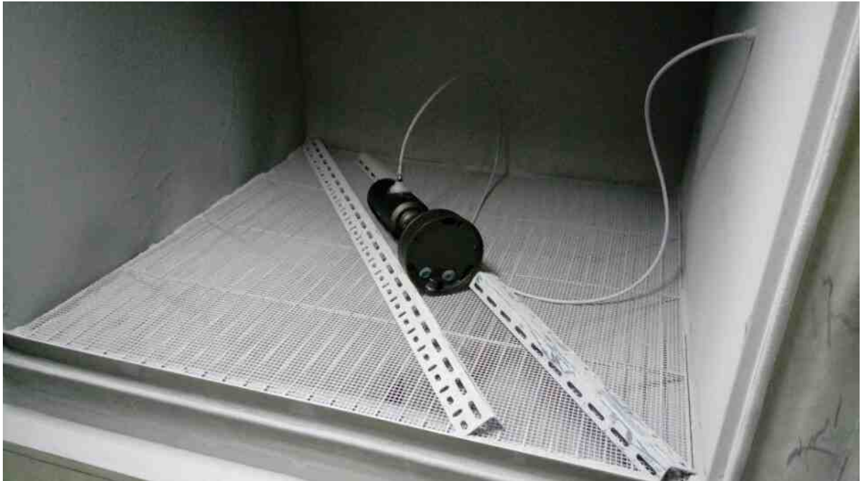
< 사진 5 > 제 1특성 숫자 시험 사진 [제 1 부분]
