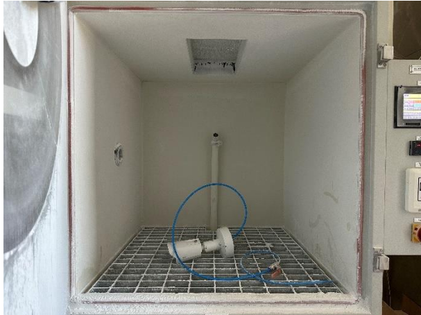
방진 시험 사진
