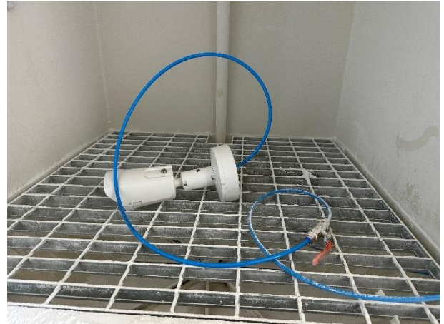
방진 시험 사진
