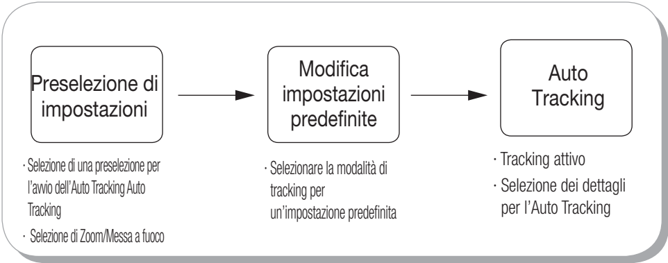
< Diagramma della procedura di impostazione di Tracking auto >
