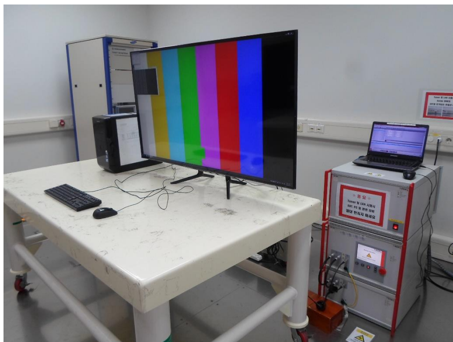
사진 14. 전압강하 및 순간정전 내성시험
