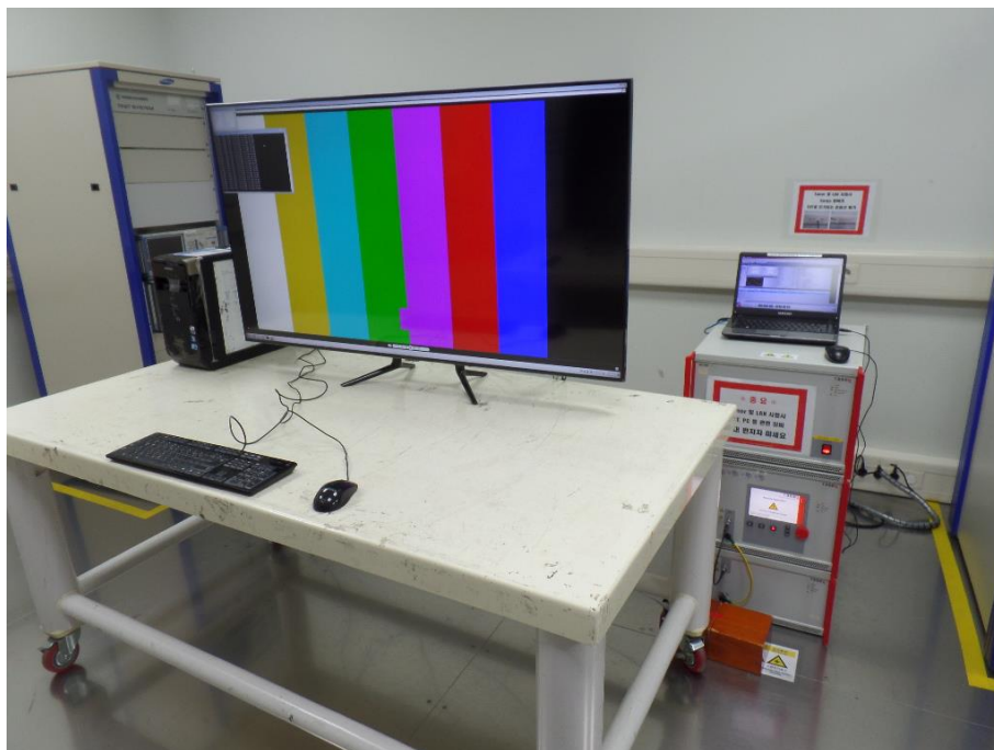
사진 14. 전압강하 및 순간정전 내성시험
