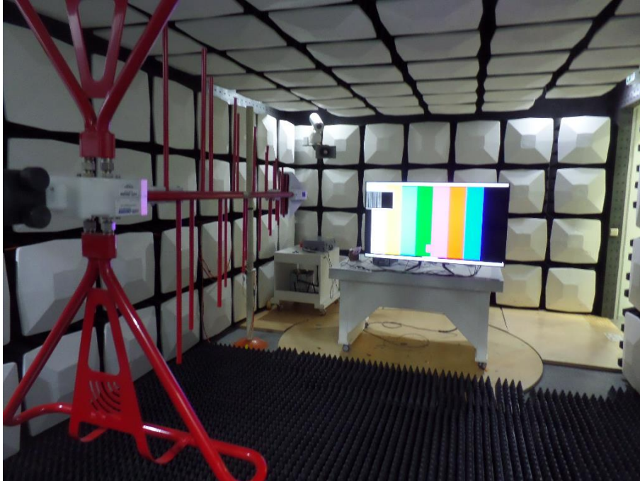
사진 9. 방사성 RF 전자기장 내성시험
