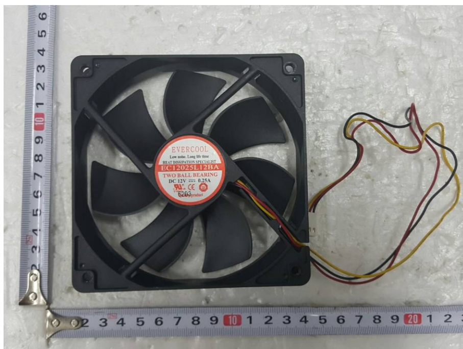
<Photo 17 > Main DC Fan
