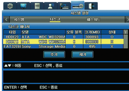
그림 2.6.12 하드 디스크 드라이브를 사용하지 않도록 설정된 디스크 매니저 메뉴
