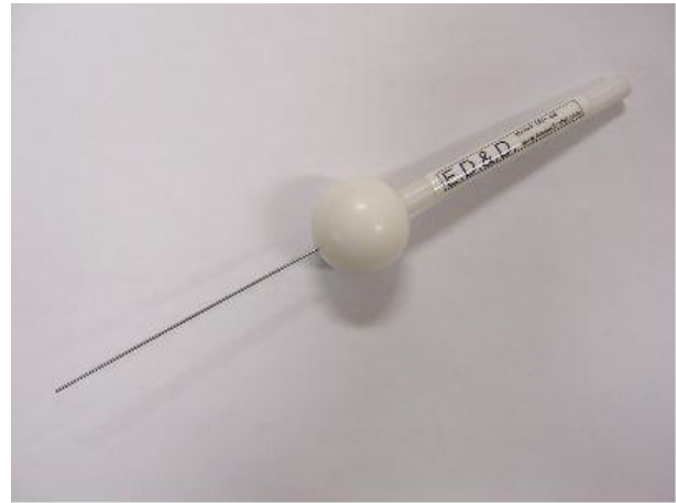
Test Rod Probe Ø1.0
