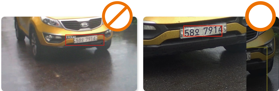
그림 12) 차량 번호판 가로 길이 150픽셀 설정의 올바른 예시
