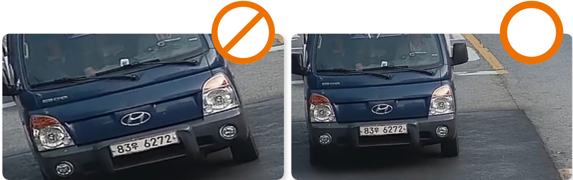
그림 16) Roll 각의 올바른 예시
