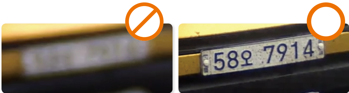
그림 17) 포커스 설정의 올바른 예시
