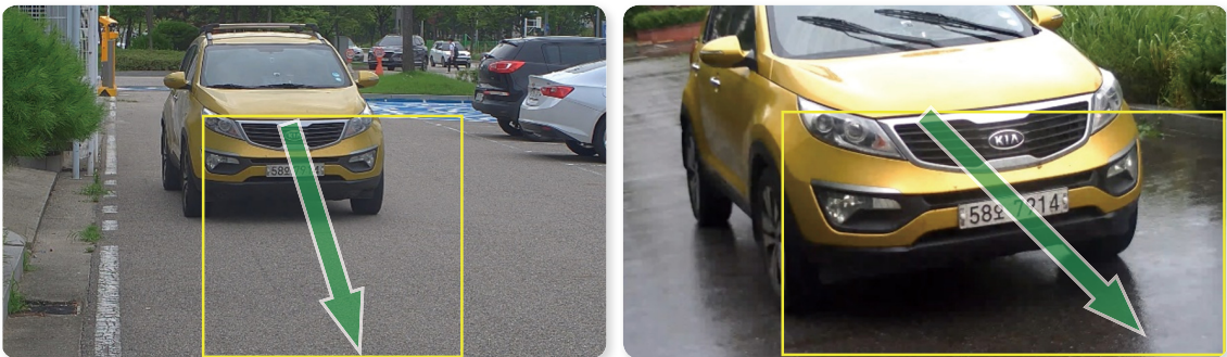
그림 7) 차량 진입 방향에 따른 차량 인식 영역 설정 예시
