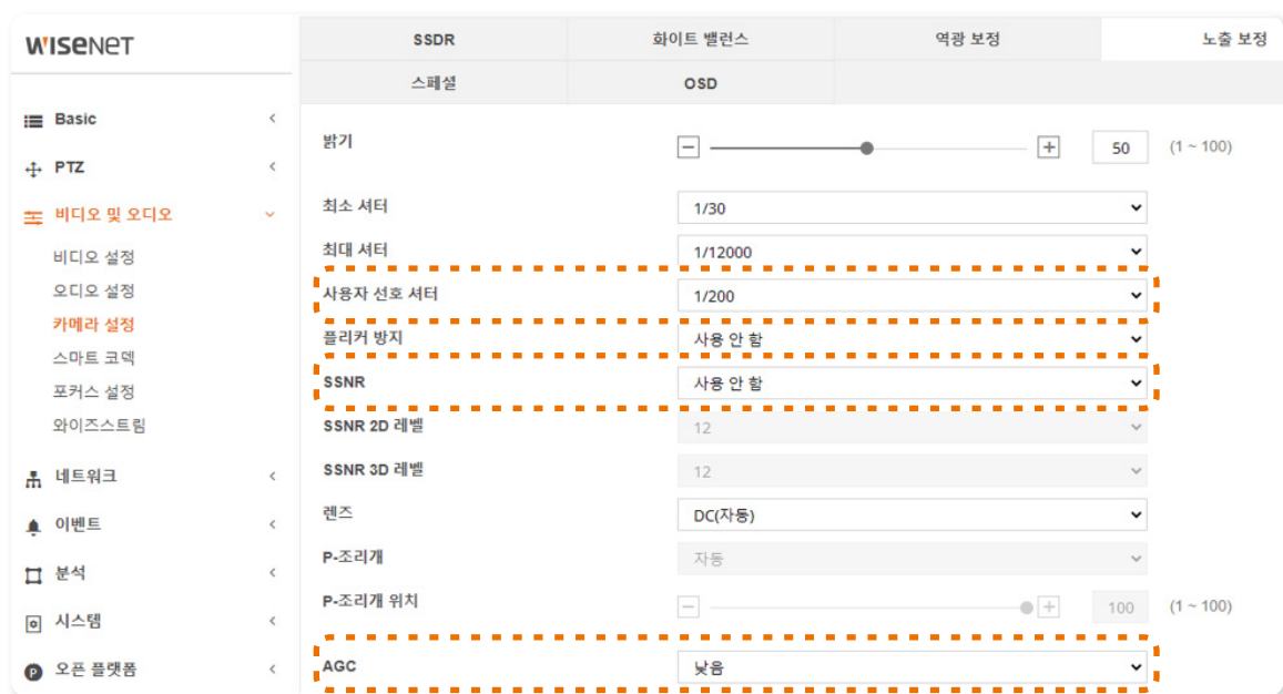
그림 18) 카메라 IP 페이지 → 좌측 비디오 및 오디오 메뉴 → 카메라 설정 → 노출 보정 탭에서의 설정 화면
