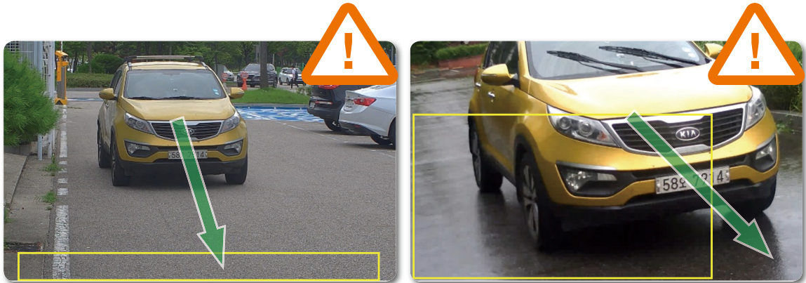
그림 8) 권장하지 않는 차량 인식 영역 설정 예시
