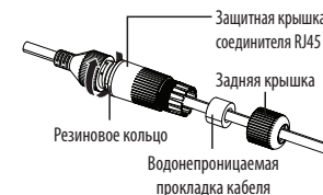
Соединитель RJ45 (вилка) Модульный разъем RJ45 (розетка) Резиновое кольцо
